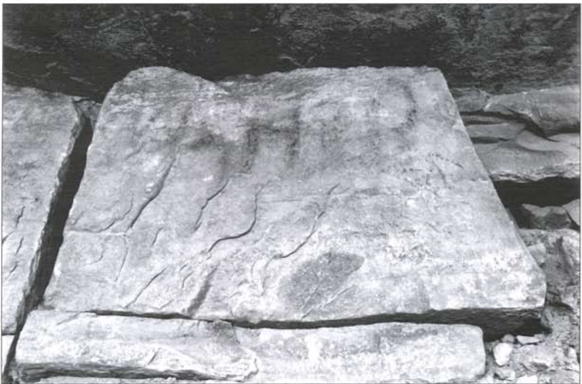
Foto 7.a: antes del tratamiento. Graffiti: WHB; material: carbón; tratamiento: cepillo de dientes suave en medio húmedo (agua destilada).
